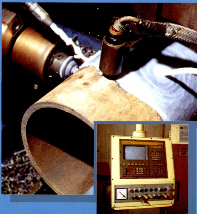
Furação para as válvulas
